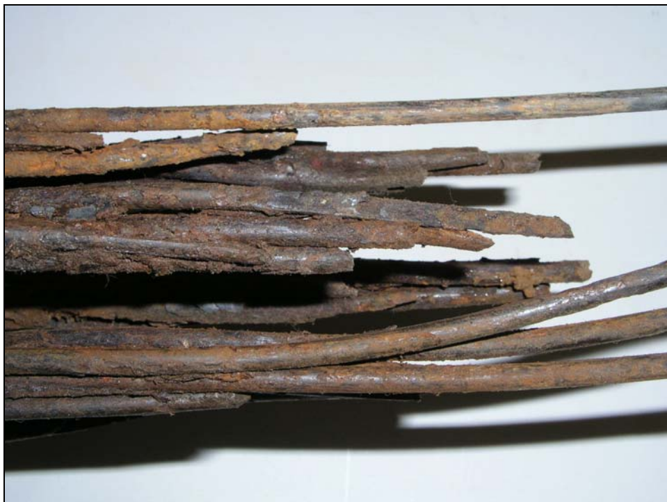
Bild 6: Detail aus Bild 5, Bruchzone, entfettete Litzen.
