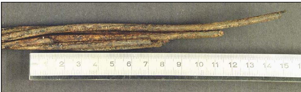
Bild 8: Entfettete Litze des Kontrollankers; Bruchbereich; Litze mit braunen Korrosionsprodukten bedeckt.
