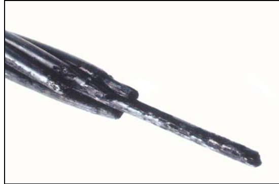
Bild 4: Gebrochenes Litzenende mit starkem Materialabtrag an den äusseren Drähten.
