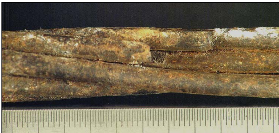
Bild 12: Detail aus Bild 11 , Ausschnitt 2 – 7 cm mit 2 Drahtbrüchen.
