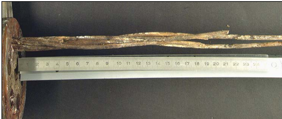
Bild 11: Litze des Normalankers; Spannkopf und Litze mit braunen, Litze streckenweise mit weiss-braunen Korrosionsprodukten bedeckt.
